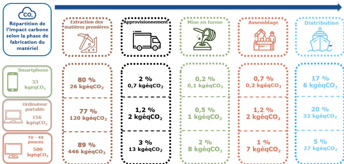
Répartition de l'empreinte carbone selon la phase de fabrication du matériel. Source : la Base Carbone ADEME.
